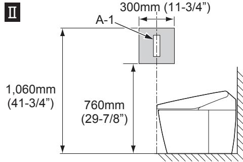
暂时安装在步骤⑨中所决定的位置后, 请确认A-1的信号接收状态。
